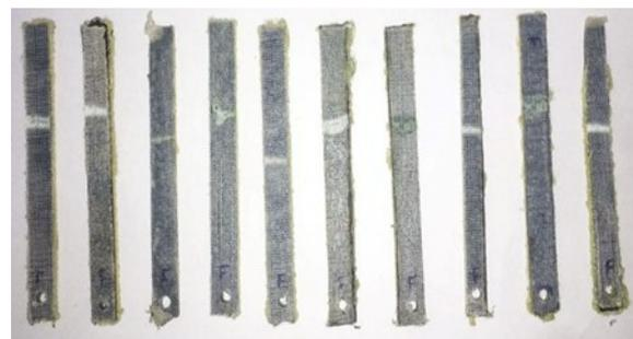
(d) Fatigue sample after test
