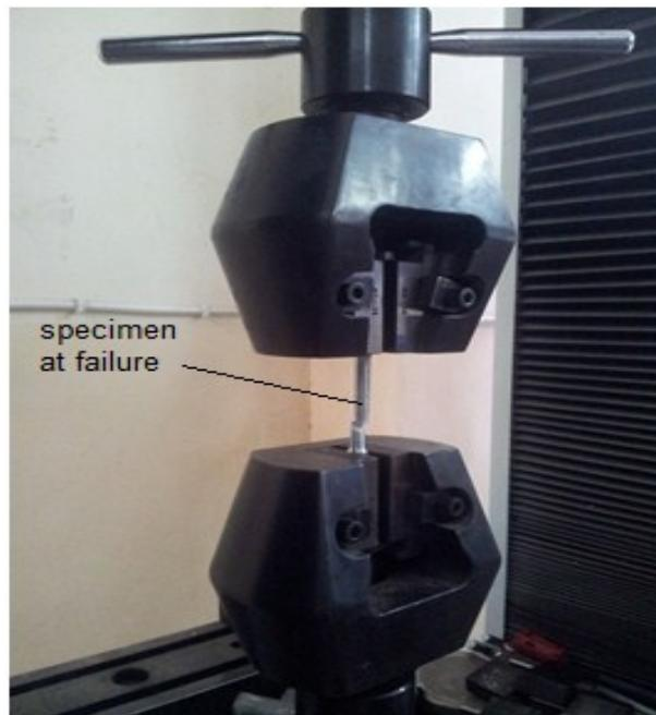
Figure 1. Tensile test rig.
