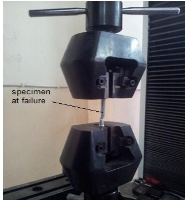
Figure 1. Tensile test rig.
